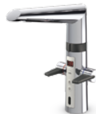
ORAS NR. 2727F, NRF nr. 4200377 Oras Optima kjøkkenkran med hendler for varmt- og kaldtvann, berøringsfri funksjon, temperaturdisplay, smart avstegningskran for oppvaskmaskin 230/5 V
